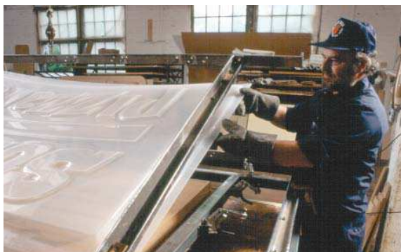
Chapas acrílicas são facilmente moldadas para aplicação em comunicação visual, mantendo os detalhes e resistência da peça.
