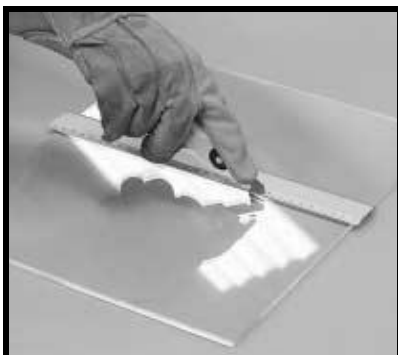
Figura 3. Demonstração do risco na chapa.
