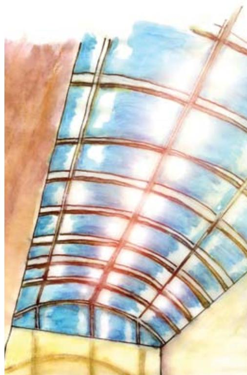
As chapas acrílicas podem ser curvadas a frio, observando-se os limites dos raios de curvatura em relação à espessura do produto
